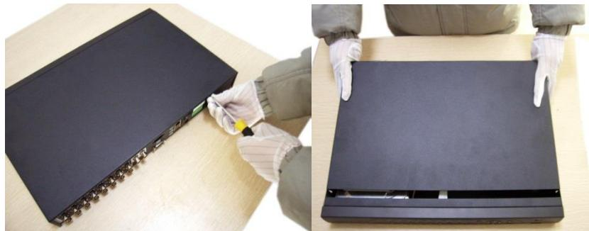
Открутите шурупы и снимите верхнюю крышку устройства
