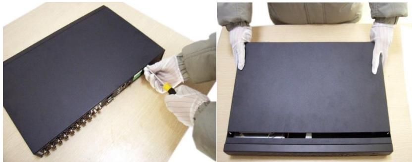
Открутите шурупы и снимите верхнюю крышку устройства
